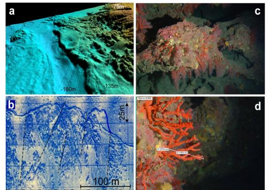
Figure 1: a) DTM da Multibeam delle pareti di paleofalesia, incise nelle lave ignimbritiche; b) registrazione side scan sonar delle vulcanite interessate da un sistema di fratture orientate N 5° e N45°; c) *C.rubrum* colonies d) CPCe Software
